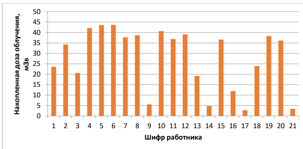
Рисунок 1 – Накопленная индивидуальная эффективная доза облучения дефектоскопистов за 2017-2020 гг.
