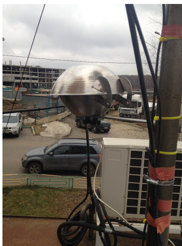
Рисунок 1 - Пассивное устройство для отбора проб, размещенное на матче АСКЗА "Кожухово"
